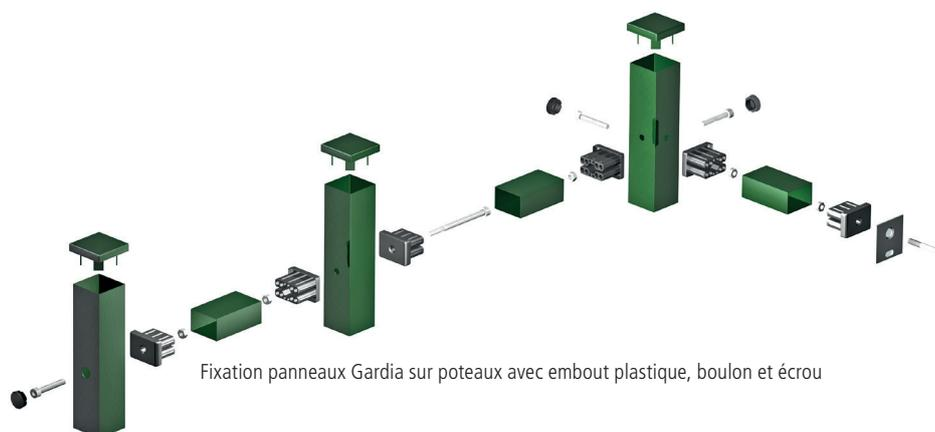
Fixation panneaux Gardia sur poteaux avec embout plastique, boulon et écrou
